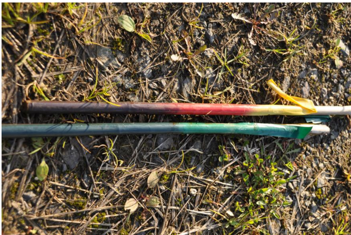
Obr. 3. Měření kolísání hladiny spodní vody pomocí bambusového prutu obaleného izolační páskou. Nejtmavší spodní úsek prutu značí část, která byla po celou dobu měření ponořena ve vodě. V místě přechodu k jasně barevnému úseku stála po většinu doby vodní hladina. Vzhledem k tomu, že je přechod tmavého a jasně barevného úseku náhlý, můžeme soudit, že v průběhu měření na lokalitě nedocházelo k výraznějším výkyvům hladiny vody, v tom případě by totiž byl přechodový pruh mezi oběma jinak zbarvenými úseky podstatně delší. Nejsvětlejší část prutu (dobře viditelné hlavně na červeně zbarvené pásce) se nacházela nad povrchem a byla vystavena slunečnímu záření. Foto E. Vicharová.
